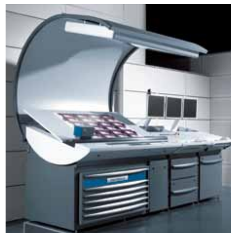
ColorPilot自动供墨导控系统—采用密度和色度测量技术的色彩测量和控制系统。
