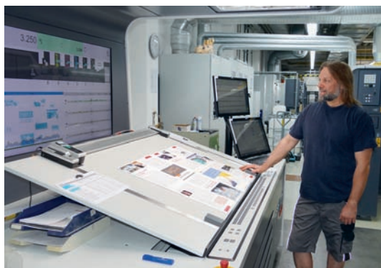
Neueste Leitstandtechnologie von manroland begeistert Offsetdrucker Norbert Lathan. Die Einstellungen über zwei Touch-Panels sowie der splitbare Monitor gestalten die Arbeit so effektiv.
